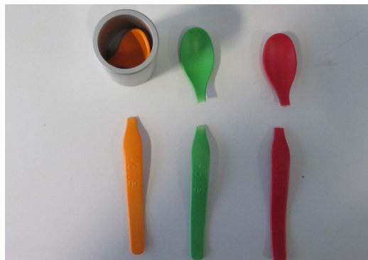
Abbildung 77 Abgebrochene Löffelköpfe und Prüfszylinder
