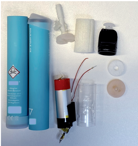
Abbildung 54: Bauteile einer Einweg-E-Zigarette
