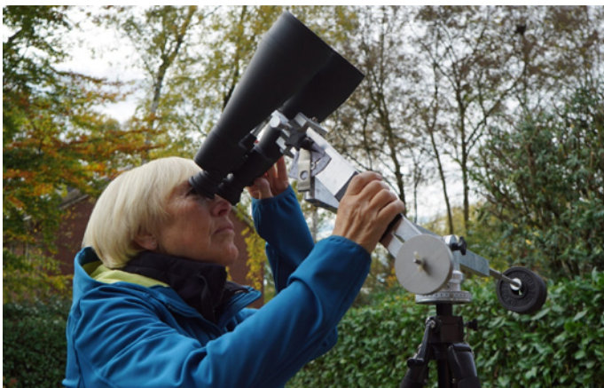
Bild 2: Für die Ausrichtung des gesamten Beobachtungsgerätes müssen nur geringe, systemisch bedingte Reibungskräfte überwunden werden. Diese halten danach das 20x80-Astroglas in der gewünschten Position.
