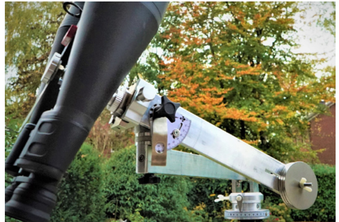
Bild 3: Über die Alt/Az-Skalierungen lassen sich auch weniger markante Objekte und Asterismen sicher identifizieren
