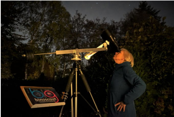
Bild 1: Das Ergebnis: Die neue, transportfreundliche 5-Achsen-Schwebemontierung für Astro-Ferngläser bis ca. 25x100 / 4,5 kg auf Kurbelstativ.
