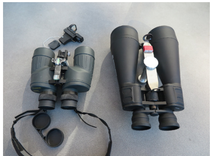
Bild 4: Die Zielhilfen bringen vor allem an Orten mit dunklem Himmel und entsprechend zahlreichen Feldsternen eine große Vereinfachung bei der Objektfindung
