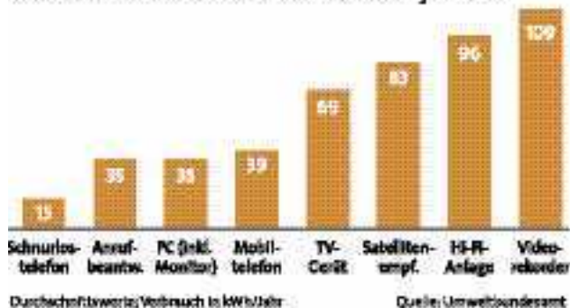
Stromverbrauch verschiedener Geräte im Stand-by-Betrieb
