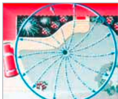
1. Bild: Herkömmlicher Rasensprenger – das Wasser wird über den Rasen hinaus auf Gartenweg, Auto und Terrasse geworfen.
