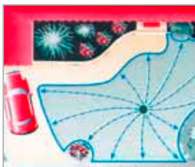
2. Bild: Rasensprenger Gilmour Pattern Master 996: Flexibel einstellbare Speicherringe ermöglichen, dass das Wasser nur auf den Rasen gespritzt wird und alles andere trocken bleibt.
