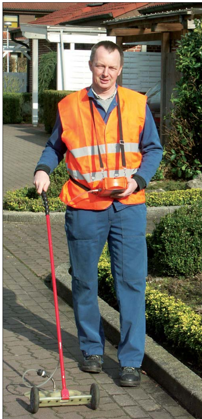
Auch sie sorgen für Sicherheit: Die Gasspürer der BEW überprüfen alle Versorgungs- und Anschlussleitungen in regelmäßigen Intervallen.
