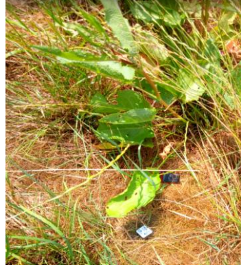
Abb. 4: Bodenfeuchte und – Temperatur Sensoren als Teil des In-Situ Messungen. © Bodo Bernsdorf
