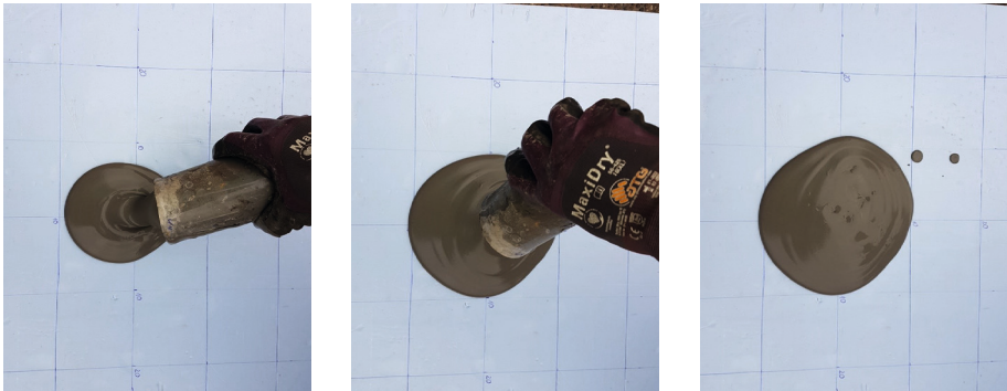
Abb. 1: Eigener Ausschüttversuch mit einem Dickstoff (Skala in [cm])
