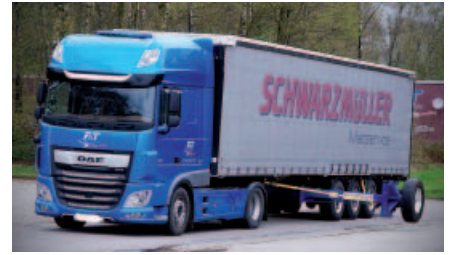
Lkw mit »Stützrädern«: Die oft extremen Fahrmanöver am LaSiSe erfordern entsprechende Maßnahmen.
