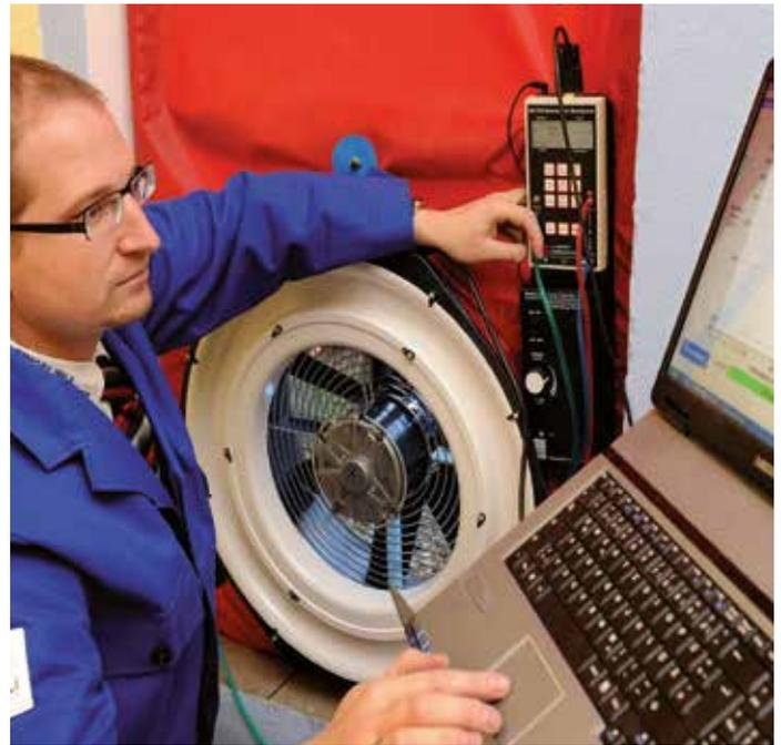
Ein Luftdichtheitstest – auch Differenzdruck-Messung genannt – dauert bis zu drei Stunden. Andreas Skrypietz (Bild) kennt die Stellen, die besonders unter die Lupe genommen werden müssen: „Überall dort, wo Bauteile aufeinanderstoßen oder das Material wechselt, können winzige Risse entstehen.“
