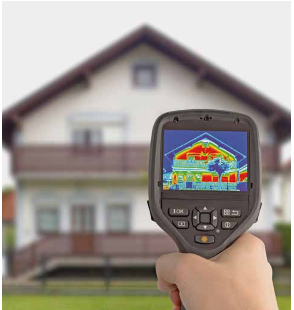
Die Thermografie zeigt deutlich, wo die Schwachstellen im Haus sind. Die roten Stellen deuten auf hohen Wärmeverlust infolge schlechter Dämmung der Außenwände hin. Das mindert die Wohnqualität und schadet dem Geldbeutel. Foto: IngImage
