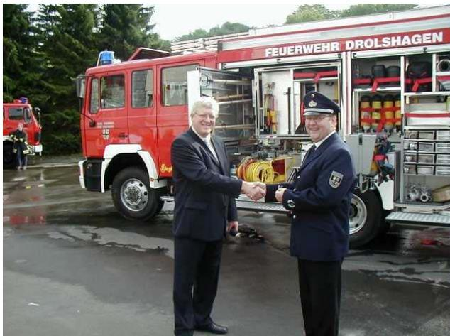
Aus den Händen von Bürgermeister Theo Hilchenbach erhielt der Leiter der Feuerwehr, Paul-Gerhard Hofacker anschließend den Schlüssel für das neue Feuerwehrfahrzeug „LF 20/16“. Dabei handelt es sich um ein 14,5 t schweres, mit einem Löschwassertank von 2.400 Litern Inhalt, einer Pumpe mit einer Förderleistung von 2.000 Liter/Minute, einem pneumatischen Lichtmast sowie
