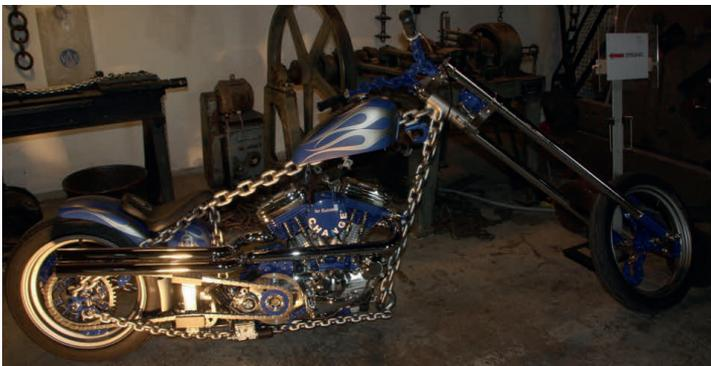
*Aus Ketten gebauter Motorradrahmen, das „Kettenmotorrad“*
