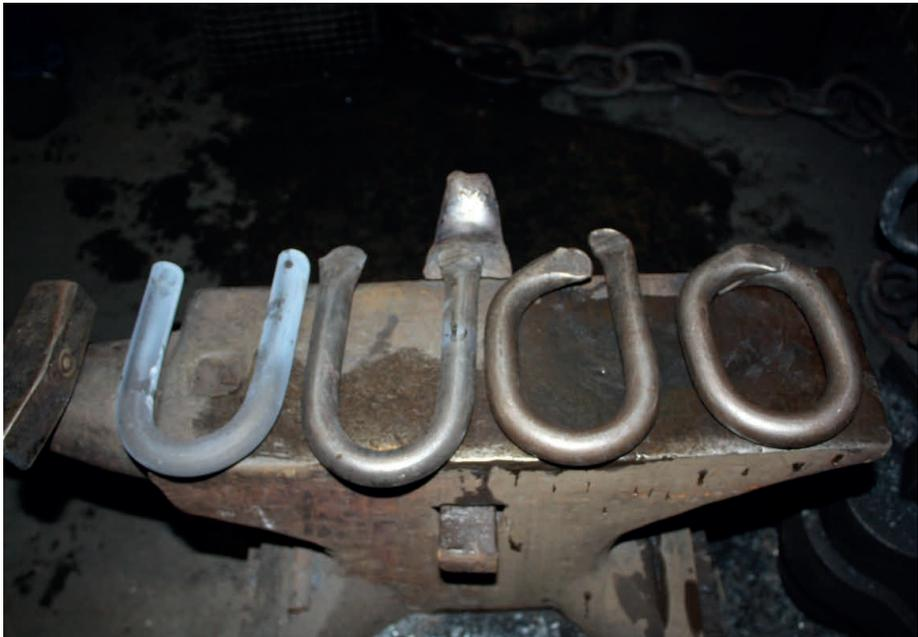
*Der „Pinn“ wird stufenweise zu einem Kettenglied geschmiedet*
