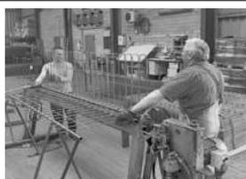
Betonstahl, Schneid- und Biegebetrieb, verlegefertig vorgeknottet,
