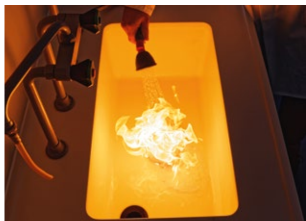
Abbildung 55–57: Spielschaum vor und bei Annäherung eines Feuerzeugs sowie beim Löschen mit Wasser
