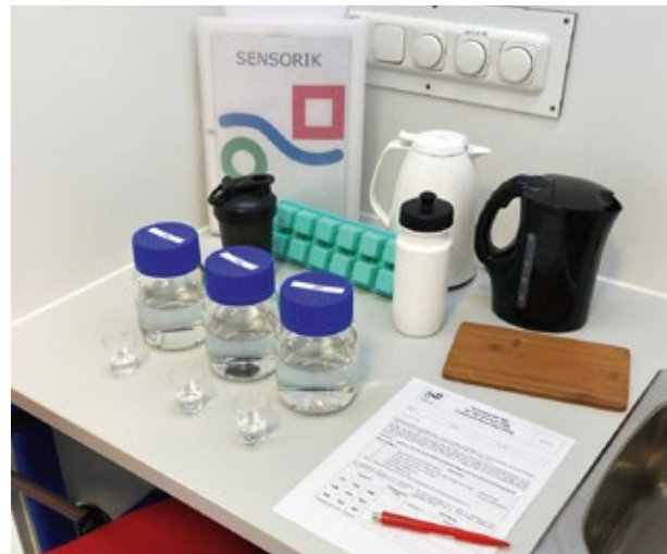
Abbildung 54: Sensorik-Prüfkabine mit Aufbau eines erweiterten Dreieckstests zur sensorischen Prüfung von Lebensmittelkontaktgegenständen und beispielhafter Darstellung von Proben
