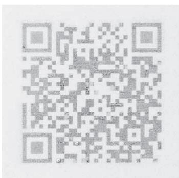
Dieser QR-Code ist im Original rund 400 Mikrometer breit. Das entspricht in etwa der Breite von sechs Haaren.
