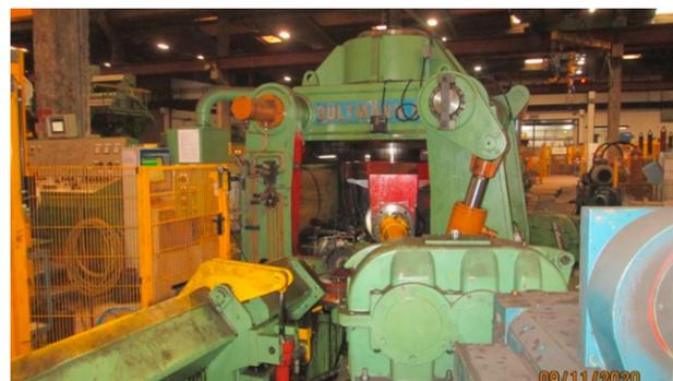
Erste »Zwei-Walzen-Richt- und Polieranlage für Stangen mit hydraulischer Klemmung« gefertigt und an einen schwedischen Kunden ausgeliefert.
