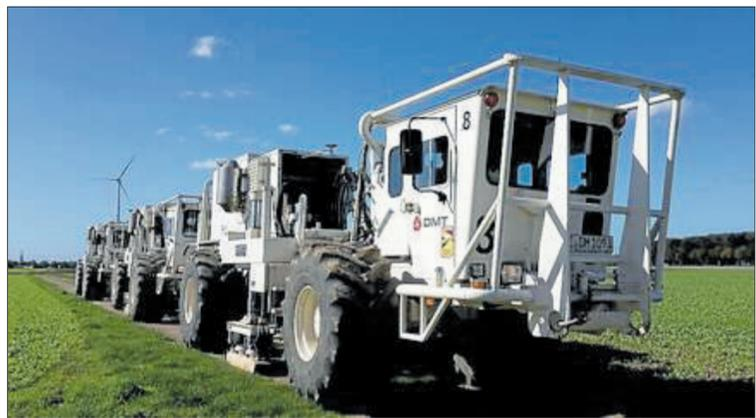
Bei den vibrationsseismischen Messungen erzeugen die Vibro-Trucks mittels einer hydraulisch absenkbaren Rüttelplatte Schwingungen.
