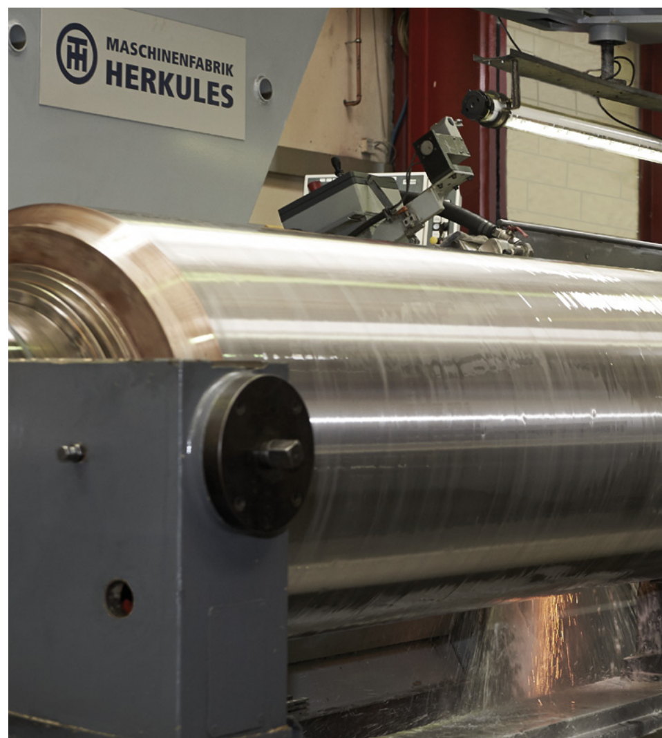
Herkules MACHtechnology - Schleifscheiben von MACH ROTEC und Maschinentechnologie von Herkules gewährleisten reproduzierbare Schleifergebnisse mit CBN-Belägen
