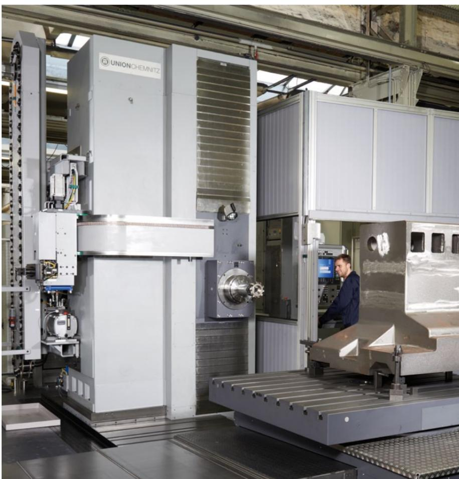
Neues, hochpräzises Horizontal-Bohrwerk von UnionChemnitz bei Herkules in Siegen
