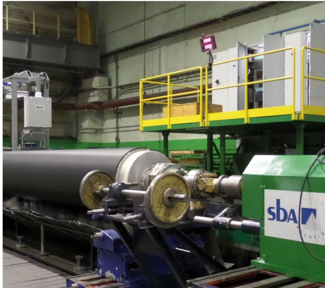
Von SBA modernisierte Dronsfield Walzenschleifmaschine für die Papierindustrie
