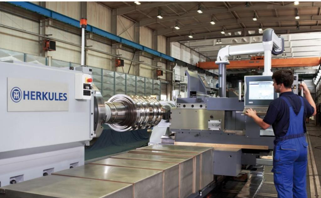
Neu entwickelte Hochleistungsdrehmaschine P 500 Power für die Badische Stahlwerke GmbH
