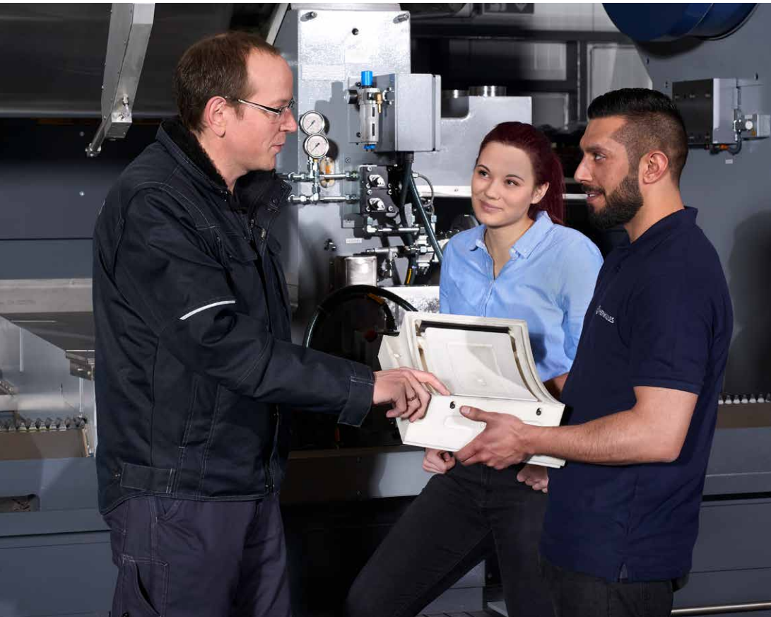
Zeitsparend: Die Lünettenbacken aus dem 3D-Drucker können manuell gewechselt werden
