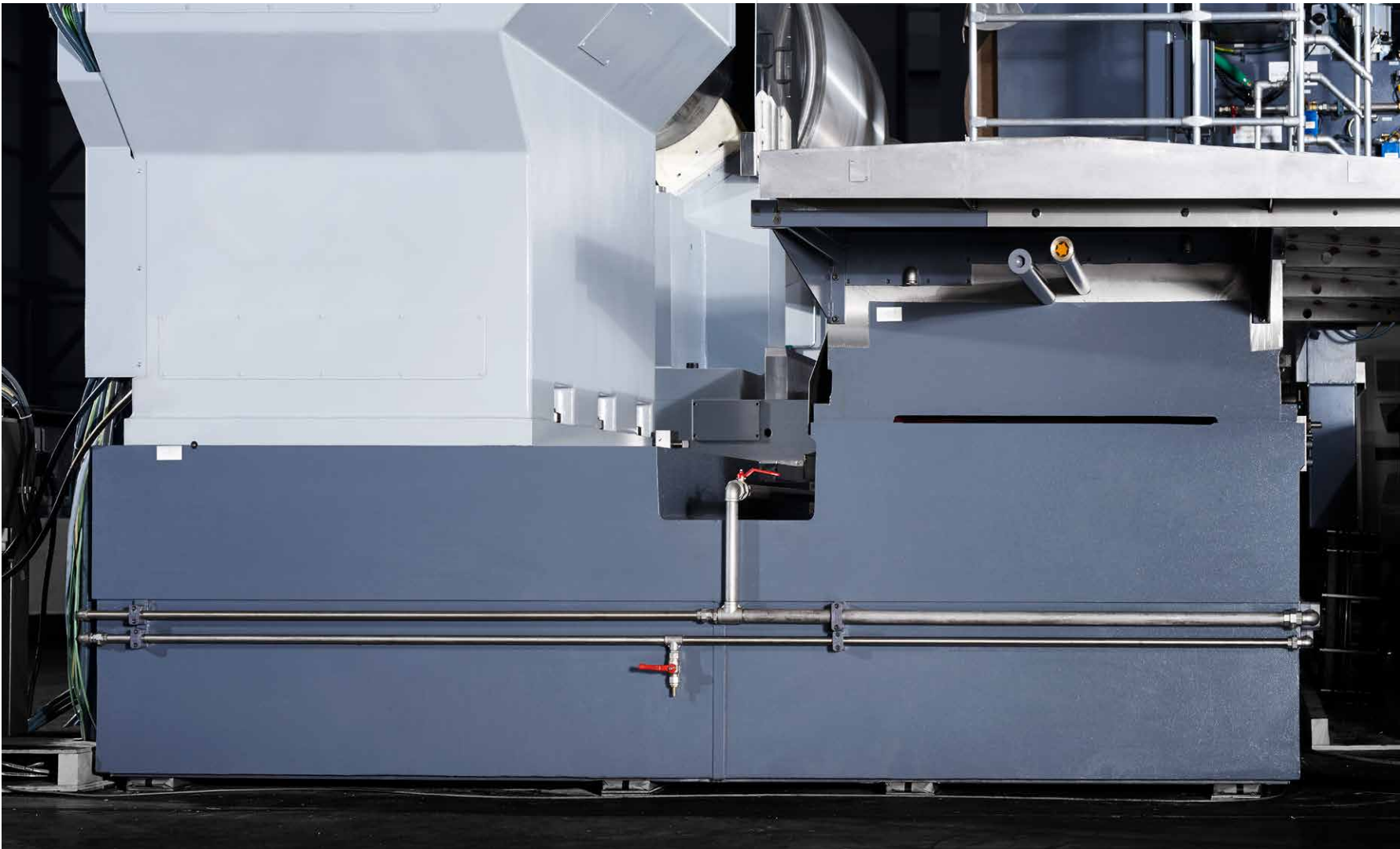
Patenterte Sandwich-Bauweise: Die Maschine wird direkt auf dem Hallenboden aufgestellt
