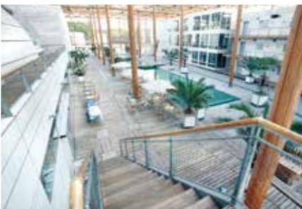
56 Fichtenstämme stützen die 180 Meter lange und 75 Meter breite Glashülle.
