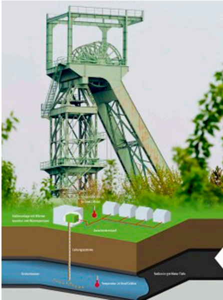
Vernünftige Energiegewinnung: Wärmenutzung des Grubenwassers auf dem Robert-Müser-Gelände (Foto Stadtwerke Bochum)
