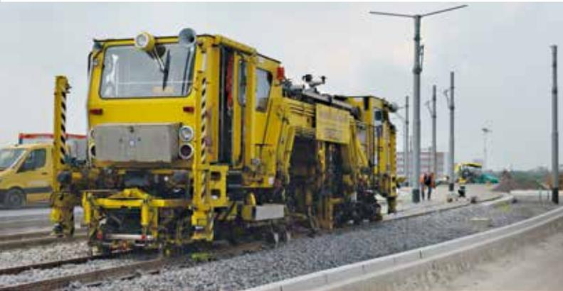
Eine „Gleisstopfmaschine“ war im September auf MARK 51°7 im Einsatz. Sie verdichtete den Schotter unter den Schwellen, um die Gleise für den späteren Betrieb vorzubereiten und belastbar zu machen. Foto: BOGESTRA
