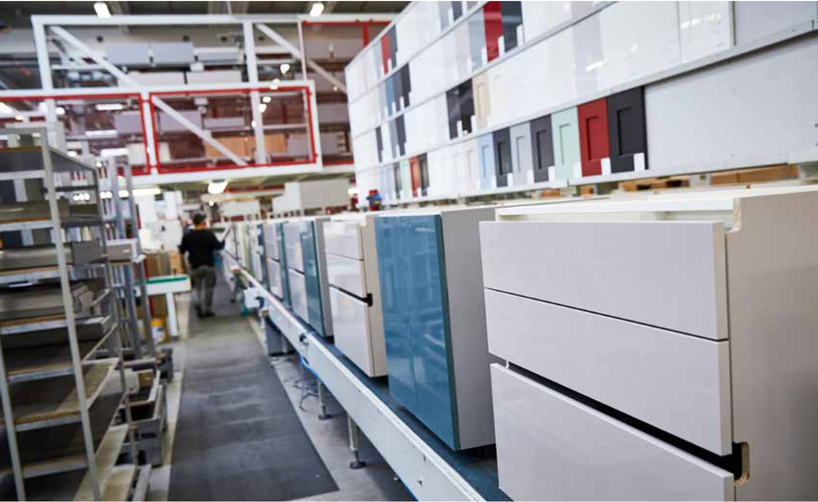
Grifflose Küchen haben einen Anteil von 30 Prozent der Produktion. Neben Holzwerkstoffen werden hier auch Aluprofile benötigt.
