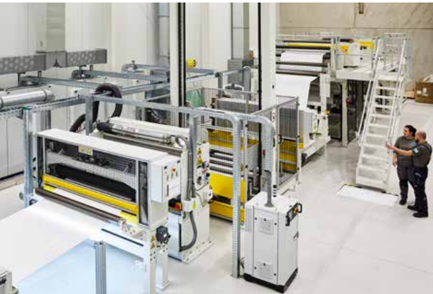
Technische Anlage Recycling only: Mittels modernster Extrusionsanlagen werden ausschließlich hochwertigste PET-Folien mit Recyclinganteil produziert.
