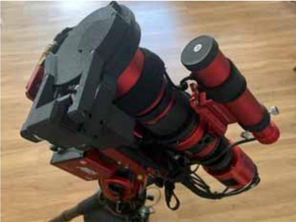
Um den Prozess zu automatisieren, bieten seit kurzem einige wenige Hersteller motorisierte Flat Panels an, die z.B. über NINA oder andere Astrofotografie Software ferngesteuert werden können. Als Leuchtmittel kommen wie bei den herkömmlichen Panels EL-Folien oder LED zum Einsatz.
