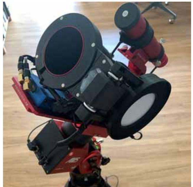
Über das ASIAIR kann das Panel dann geöffnet und geschlossen sowie die Lichtquelle angesteuert werden. Eine Vollautomatisierung mittels ASIAIR ist momentan noch nicht möglich. Dafür müssten motorisierte
