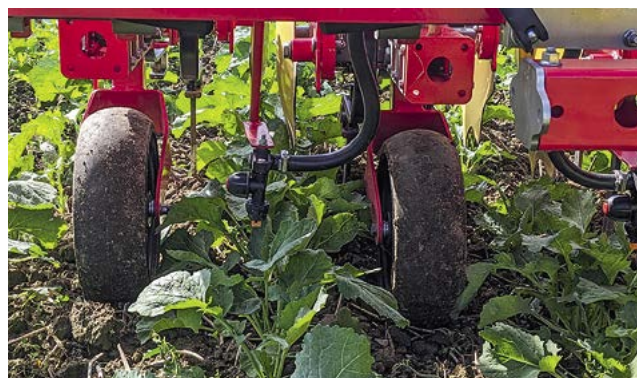
Hacke-Band-Verfahren als Alternative zur flächigen Herbizidanwendung im Praxistest.
