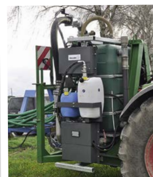
Einheit zur Ansäuerung von flüssigen organischen Düngern.
