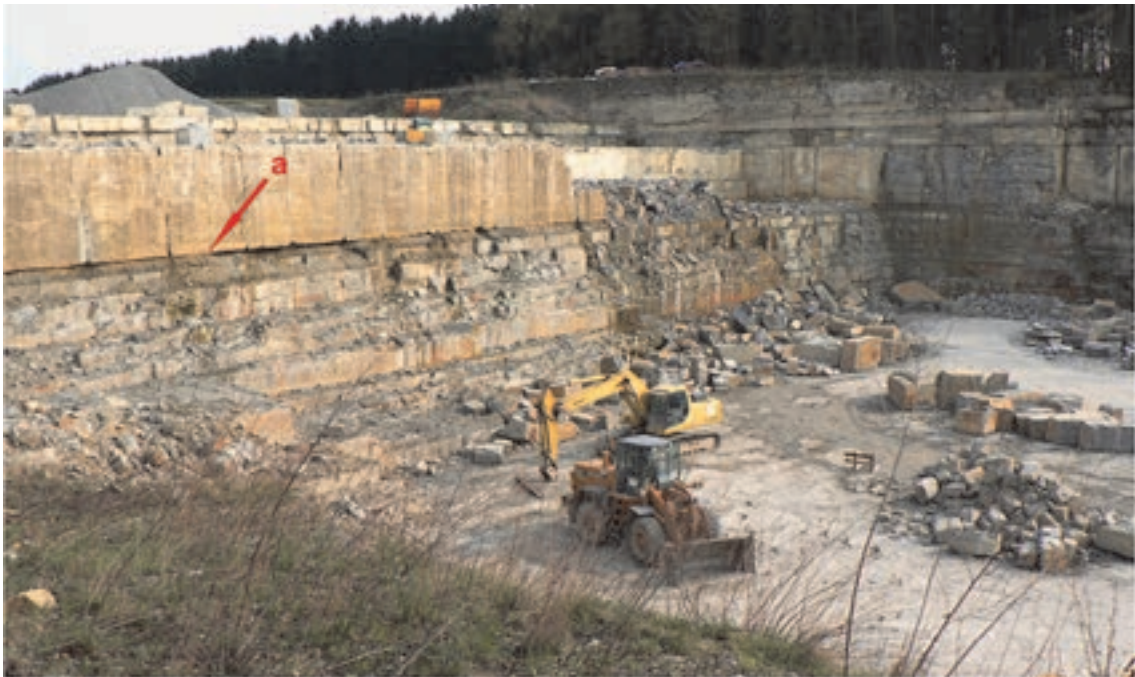
Abb. 10: Steinbruch Stelbrink, Niederntudorf, Salder-Formation mit a unterer Werksteinbank des Soester Grünsandstein, Oberturonium, obere Subprionocyclus neptuni -Zone und untere Prionocyclus germari -Zone, Gewinnung von Naturbausteinen, Herkunftsort u.a. der restaurierten Außenmauerwerke des Paderborner Doms und der Kaiserpfalz, TK 25 Blatt 4318 Borchten, Rechts 3478595, Hoch 5721260, NN + 190 m.
