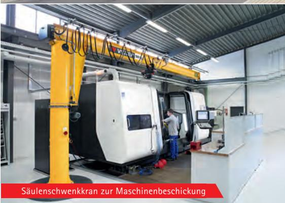
Säulenschwenkran zur Maschinenbeschickung
