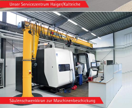
Säulenschwenkran zur Maschinenbeschickung
