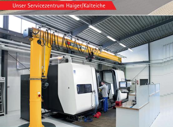
Säulenschwenkran zur Maschinenbeschickung
