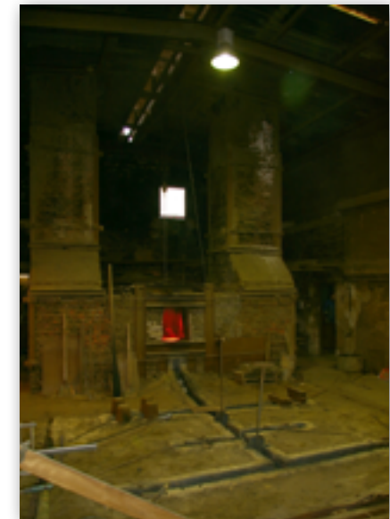
Glockengrube mit den eingedämmten Glockenformen und den fertig aufgesetzten Gussrinnen
