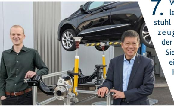
**7.** Wissenschaftler vom Lehrstuhl für Fahrzeugleichtbau der Universität Siegen haben eine neue Hinterachse für Elektrokleinwagen entwickelt.
