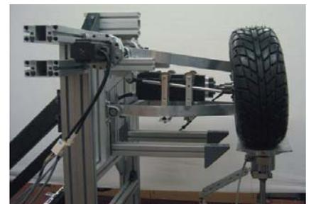
Viertelfahrzeugprüfstand für ein X-by-Wire-Fahrwerk
