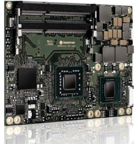
Vollständiger Rechner auf einer Platine mit allen wichtigen Bauteilen wie CPU, Chipsatz, Grafikern und Speichersockeln.
