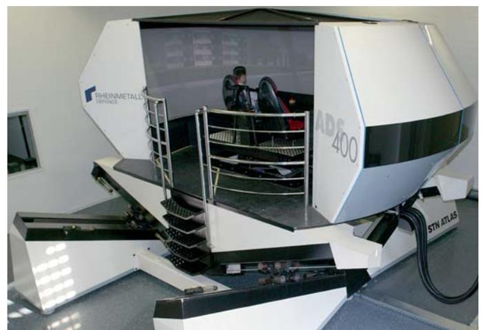
ATMOS-Fahrsimulator für die Analyse von Fahrerassistenzsystemen
