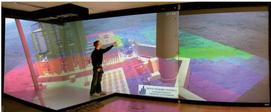
Richtungsabhängiges Rendering auf der Powerwall des HD-Visualisierungszentrums für Virtual Prototyping und Simulation
