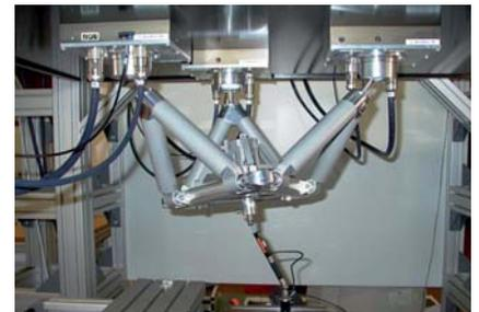
Parametrische Identifikation einer Parallelkinematik
