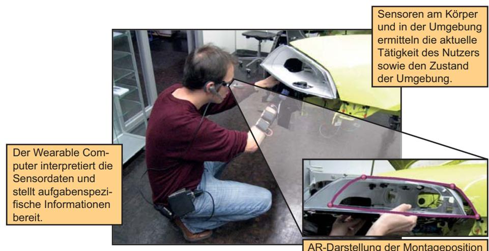
Das Wearable Computing Interaktionsparadigma: Das System stellt in Abhängigkeit der Nutzertätigkeit und des Umgebungszustands Informationen automatisch bereit.
