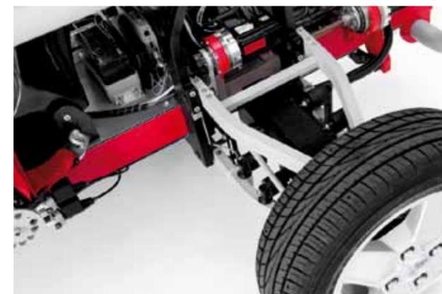
Radmodul mit drei Elektromotoren
