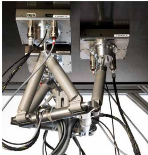
TriPlanar – Roboter mit Parallelkinematik und sechs Freiheitsgraden
