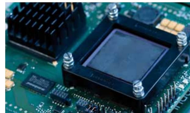
Die CoreVA ASICs werden im RAPTOR Rapid-Prototyping-System getestet.
