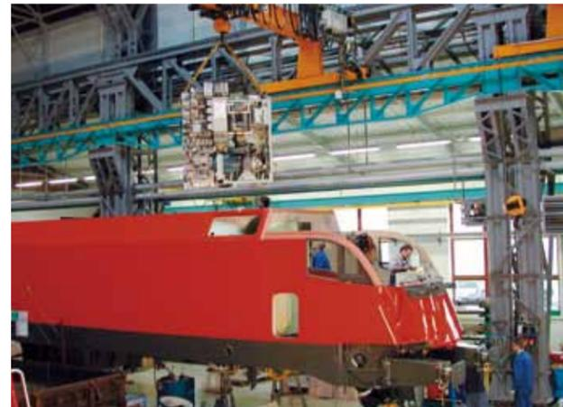
Einkranen einer modularen Bremssteuerung (in Taurus Lok)
