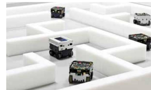
Verschiedene BeBot-Miniaturroboter in einem Multi-Roboter-Experiment auf der Telewerkbank
