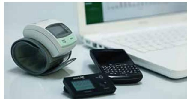
Endgeräte des telemedizinischen Assistenzsystems: Smartphone, Blutdruckmessgerät und Aktivitätsmessgerät (© COMES®)
