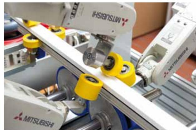
Prüfstand für Versuche zur robotergestützten Profilmantelung.
