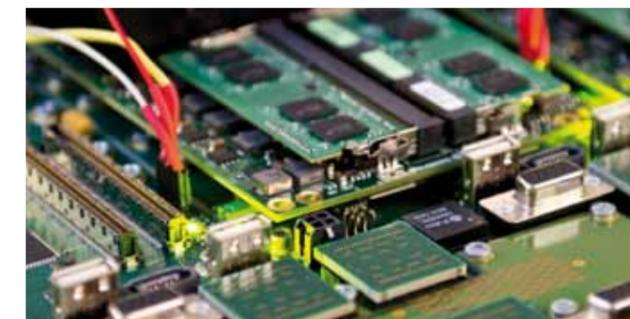
Einzelner RECS-Rechenknoten mit CPU, Speicher und Schnittstellen
