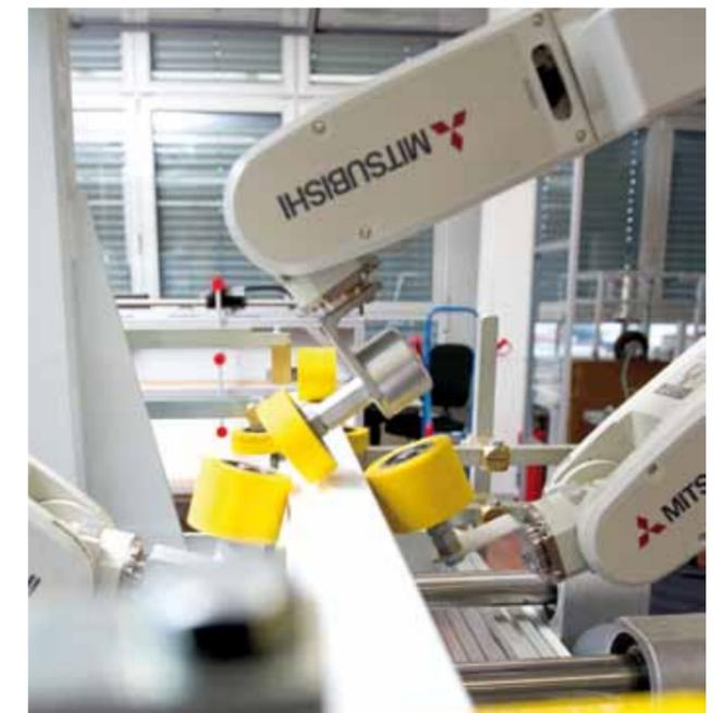
Prüfstand für Versuche zur robotergestützten Profilmantelung
