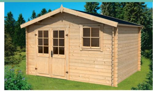
Blockbohlen aus nordischem Fichtenholz, naturbelassen, Wandstärke 28 mm, Dach aus 15 mm Nut- und Federbrettern, Fußboden aus 18 mm Nut- und Federbrettern, inkl. 45 x 45 mm imprägnierten Fundamentbalken, inkl. PZ-Schloss, Drückergarnitur und Schraubenmaterial, Fenster und Lichtausschnitte mit Echtglas, Doppeltür mit Gehflügel DIN rechts, inkl. Dachpappe
