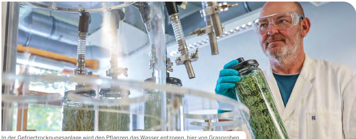
In der Gefriertrocknungsanlage wird den Pflanzen das Wasser entzogen, hier von Grasproben
