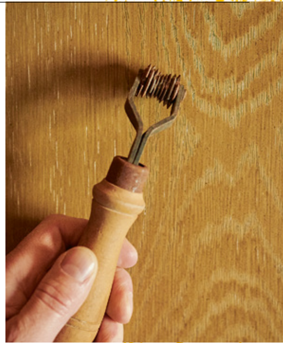
Allein das Einritzen der Eichenstruktur mit Porenwalze und Nadel dauert mehrere Stunden
