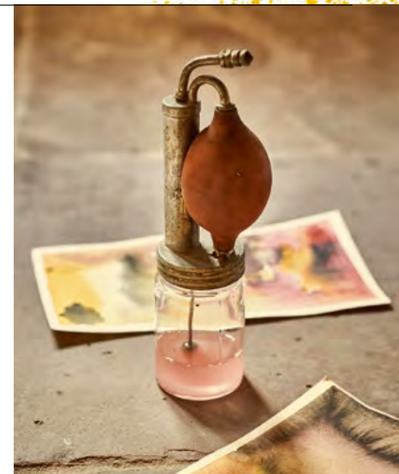
Beim Zerstäuber entsteht durch das Zusammendrücken des Pumpballs mit der Hand ein Überdruck, so wird die Farbe über die Düse fein zerstäubt
