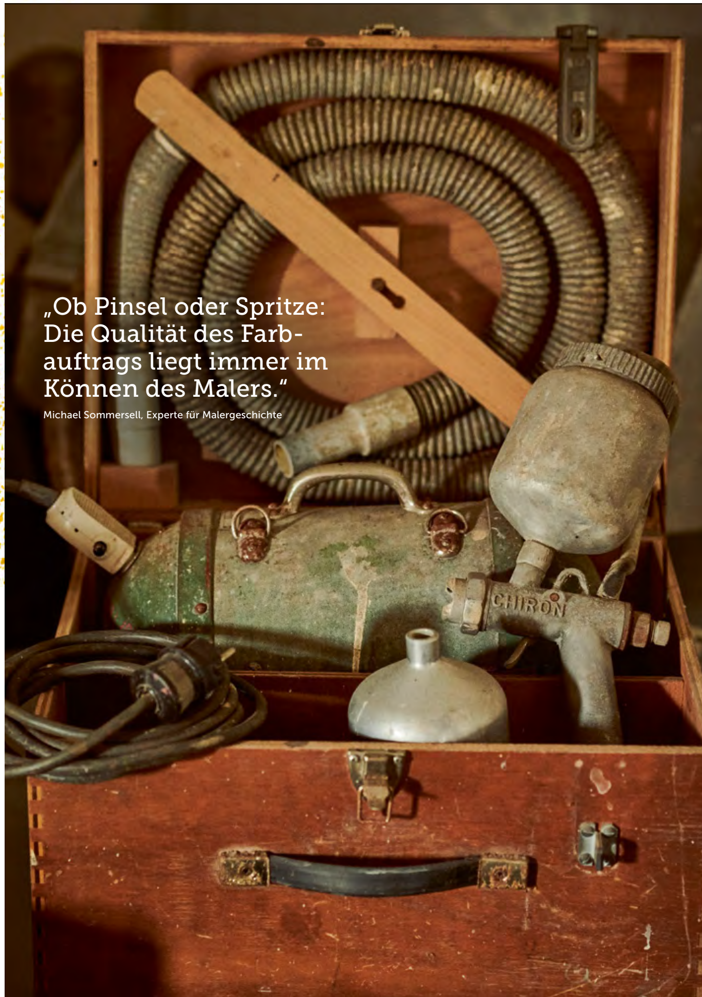
Technik to go: Das Chiron-Gerät begleitete Maler in den 1950er- und 1960er-Jahren handlich verpackt im Koffer
