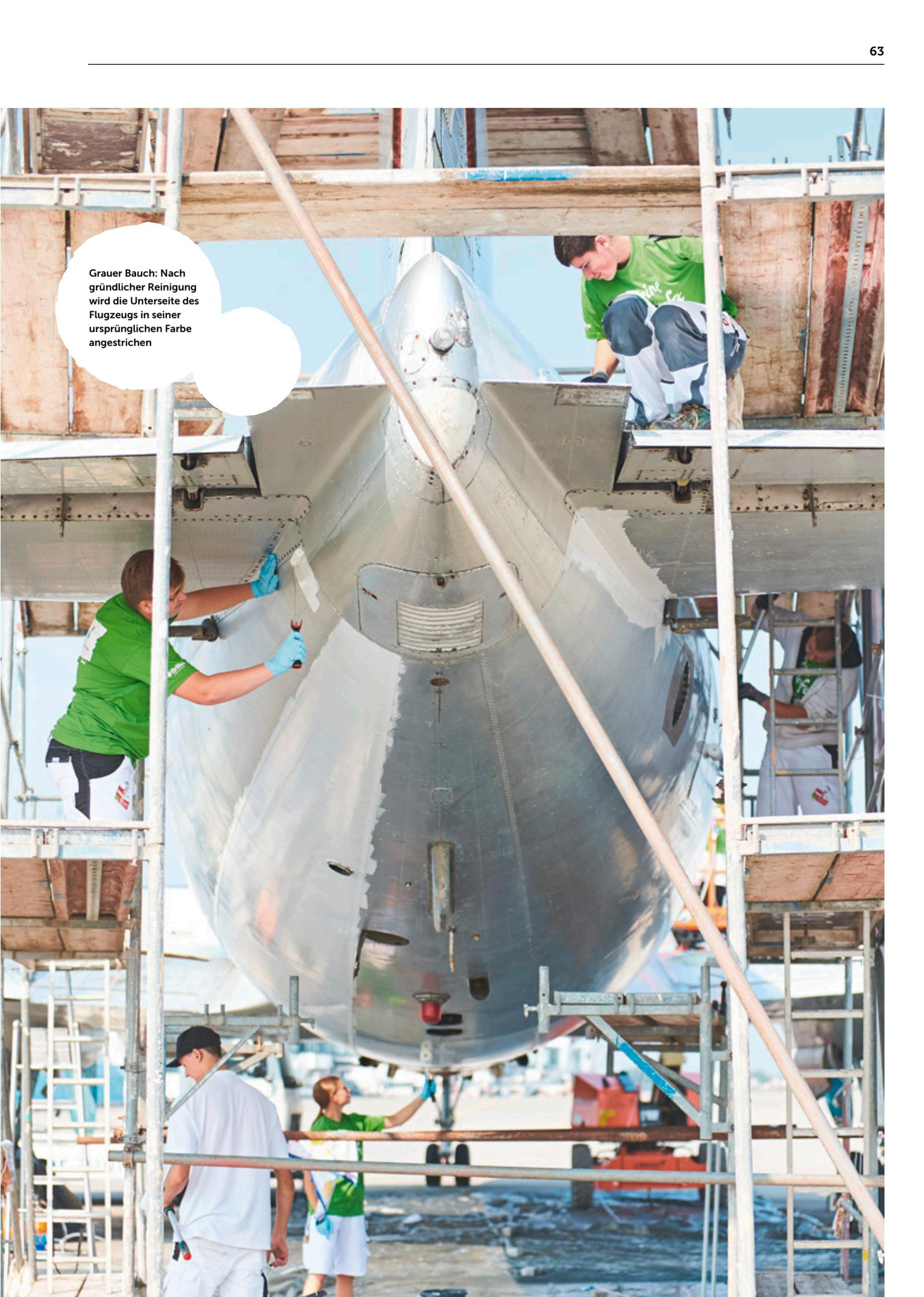
Grauer Bauch: Nach gründlicher Reinigung wird die Unterseite des Flugzeugs in seiner ursprünglichen Farbe angestrichen
