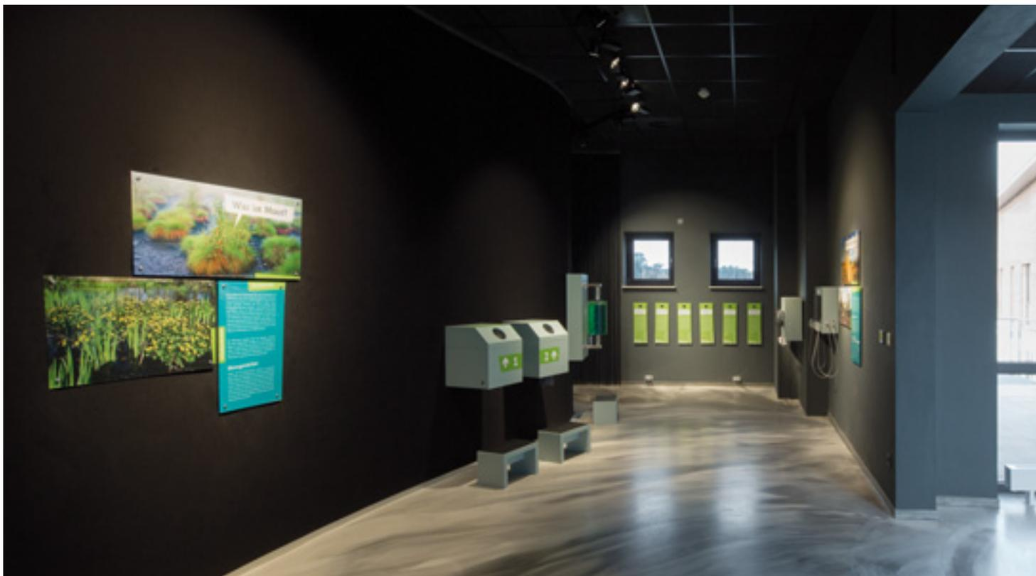
Nach einer kurzen Trockenzeit wurde der Boden mit einer zweifachen Beschichtung versiegelt, nachdem die Fläche ein weiteres Mal poliert und entstaubt wurde.
