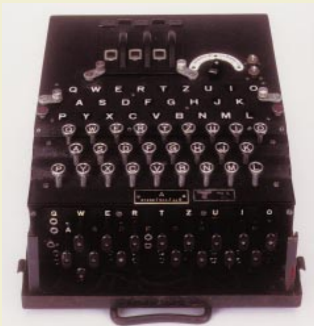
Abb. 1: Die deutsche ENIGMA-Chiffriermaschine aus dem 2. Weltkrieg. Dieses Exemplar steht im Heinz Nixdorf MuseumsForum, Paderborn.
