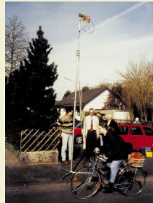
Abb. 8: Funkkanalvermessung. Empfängerantenne für 30 GHz und Signalvorverarbeitung sind auf dem Antennenmast montiert, der Rest des Empfängers ist im Kraftfahrzeug untergebracht. Der Sender steht woanders.
