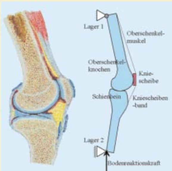
Abb. 5: Schnittdarstellung des Kniegelenks und mechanisches Modell für die Kniebeuge.
