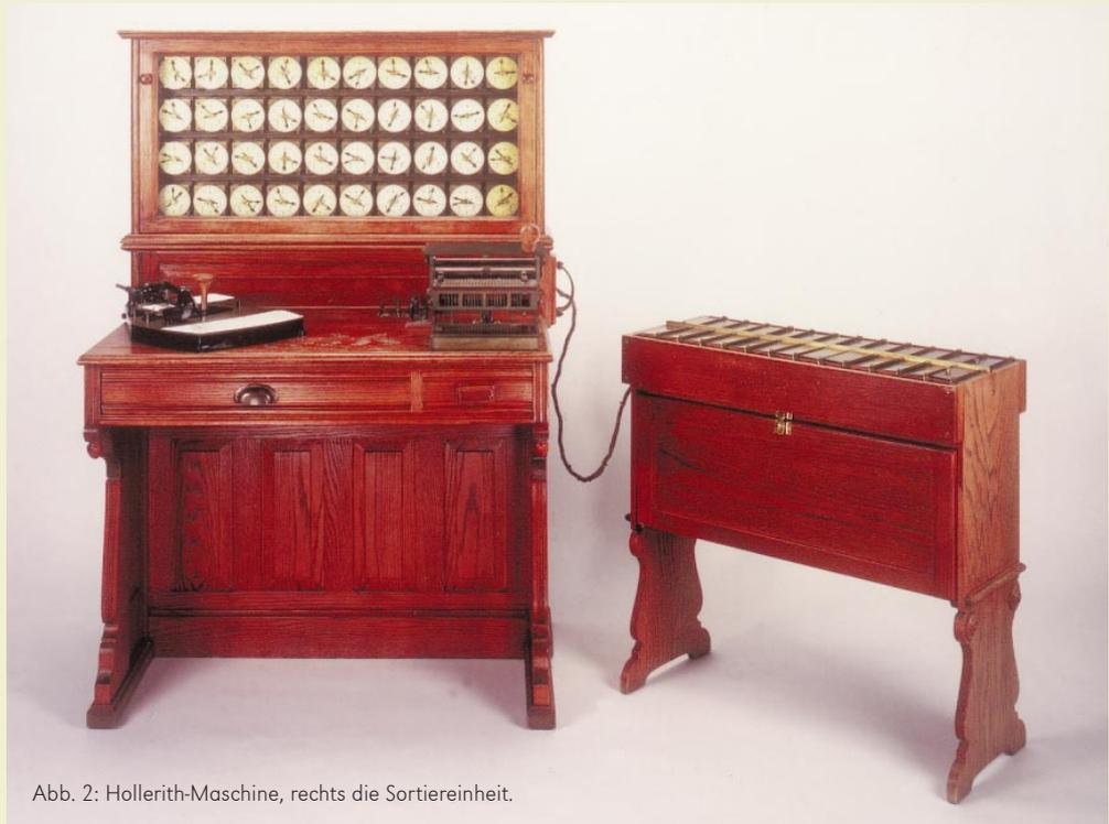
Abb. 2: Hollerith-Maschine, rechts die Sortiereinheit.
