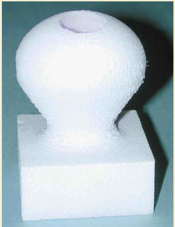
Abb. 6: Aus Blockschaumstoff gefrästes Modell.
