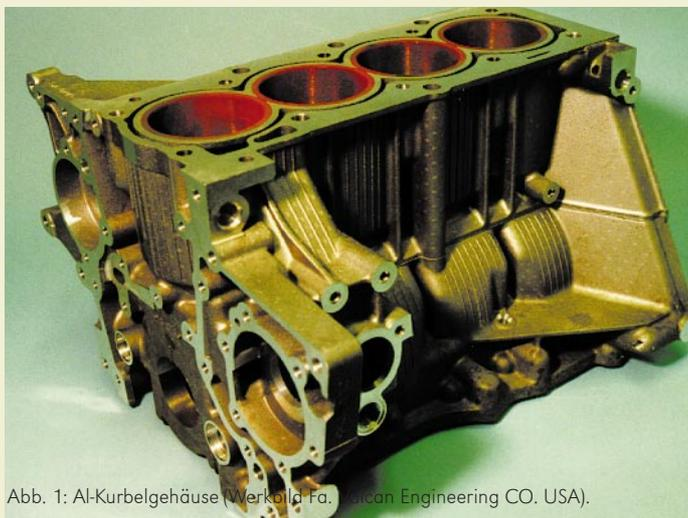
Abb. 1: Al-Kurbelgehäuse (Werkstoff: Alu, Hersteller: Incon Engineering CO. USA).
