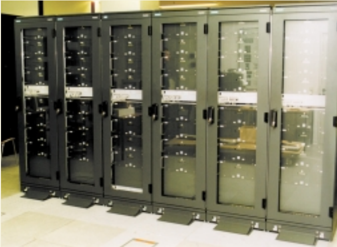
Abb. 2: Parallelrechner, wie die Siemens hpcLine des PC 2 mit 192 Prozessoren, helfen bei der Berechnung großer Fleet Assignments.
