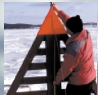
Entfernung vom Tangentialpunkt 5 000 Meter - Abstand der Tangente von der Erdoberfläche ca. 186 Zentimeter.
