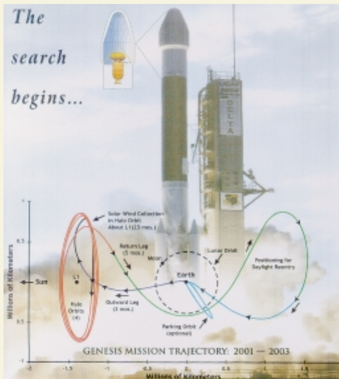
Abb. 9: Schematische Darstellung der Flugbahn des Raumfahrzeugs zum Halo-Orbit und zurück zur Erde.
