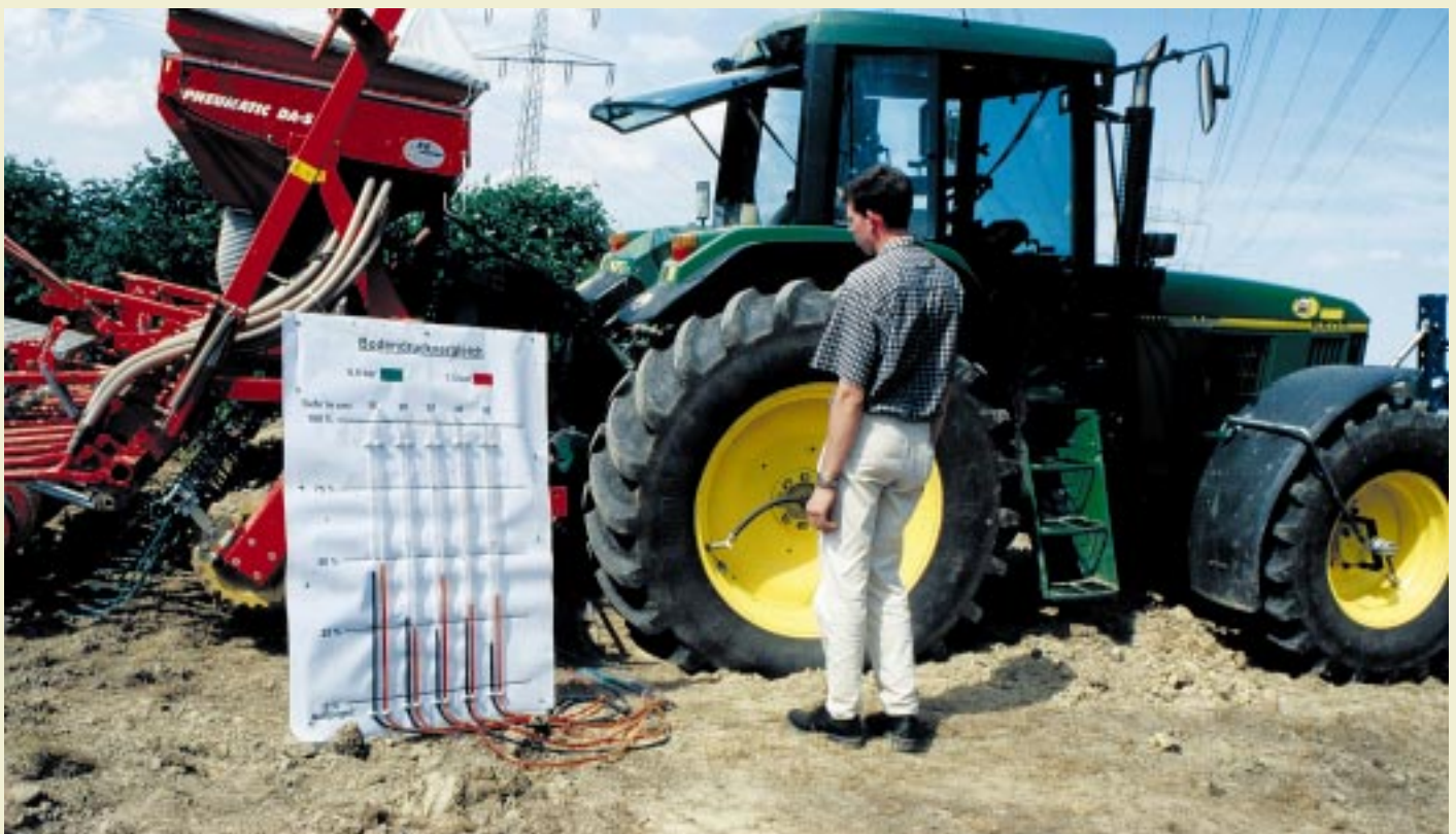
Traktorhinterrad auf dem Acker mit hoher Last und im Boden eingegrabenen Schlauchsonden. Mit Schlauchsonden, platziert in 10, 20, 30 und 40 Zentimeter Tiefe, wird die Druckübertragung im Boden dargestellt.
