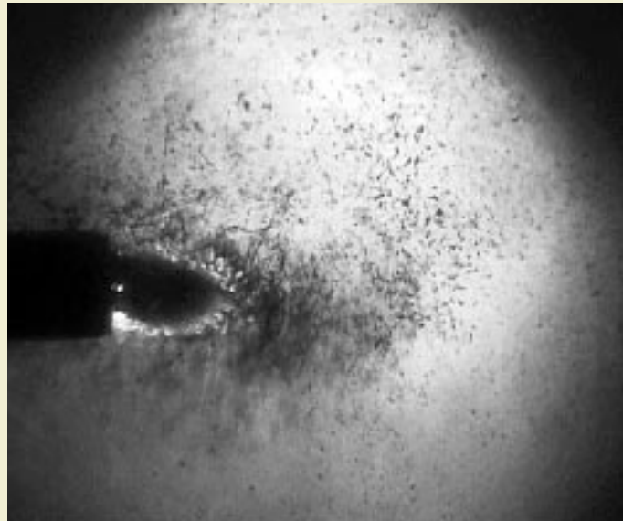
Abb. 2: Blitzlicht-Fotografie der Zerstäubung eines Flüssigkeitsstrangs im Ultraschallfeld.
