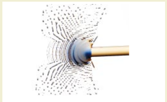
Abb. 5: Simulation der Zerstäubung eines kontinuierlichen Flüssigkeitsstrangs in einem resonanten Ultraschallfeld.
