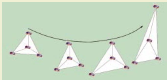
Abb. 4: Deformation einer Tetraeder-Formation beim Flug durchs All.
