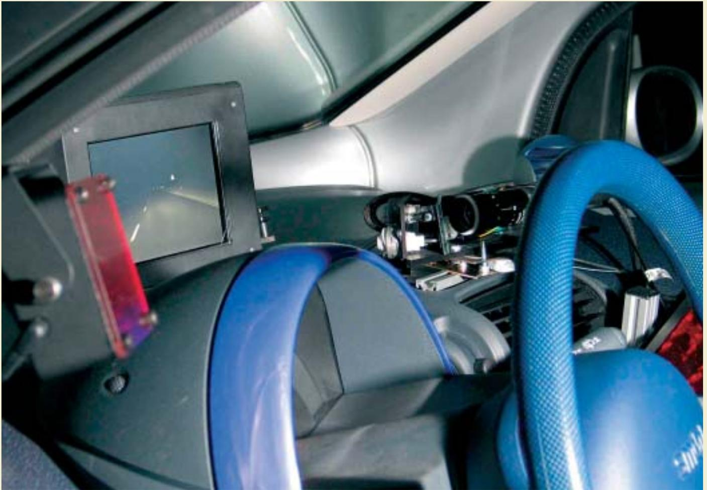
Abb. 6: Night Vision Display und Eye-Tracking-System im Simulator.
