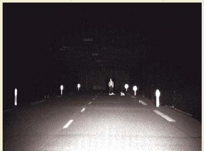
Abb. 3: Night Vision Bild im Lichtkanal. Entfernung der Sehhobjekte ca. 80 m.
