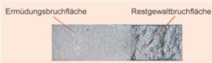
Abb. 2: Unterschied zwischen Ermüdungsbruch- und Restgewaltbruchfläche bei einem hochfesten Stahl.
