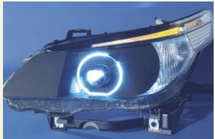
Abb. 2b: DMD-Aktiver Scheinwerfer integriert in ein Serien-Scheinwerfer-Gehäuse.
