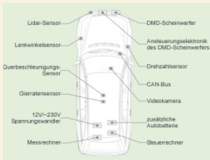
Abb. 4: Komponenten des Versuchsfahrzeugs.
