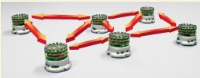
Abb. 1: Bildmontage des im SFB 376 Massive Parallelität, Teilprojekt C6, Mobile Ad-hoc-Netzwerke entwickelten Mobil Ad-hoc-Netzwerks mit Mini-Robotern Khepera und angedeuteter Infrarot-Kommunikation.
