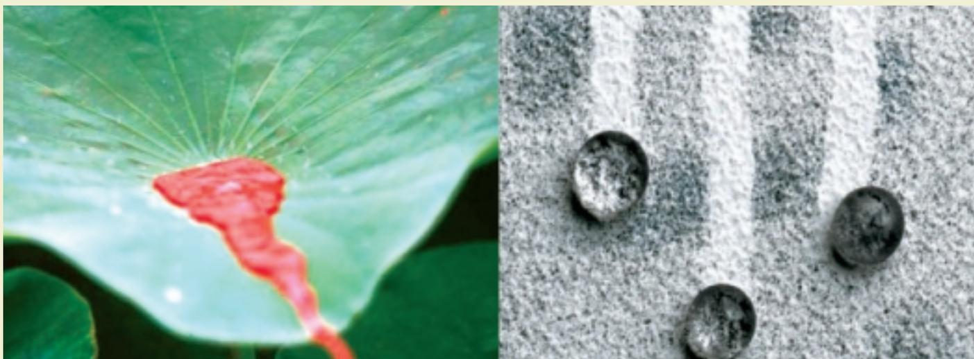
Abb. 1: Lotusblatteffekt in der Natur sowie bei einer neuartigen Fassadenfarbe.
