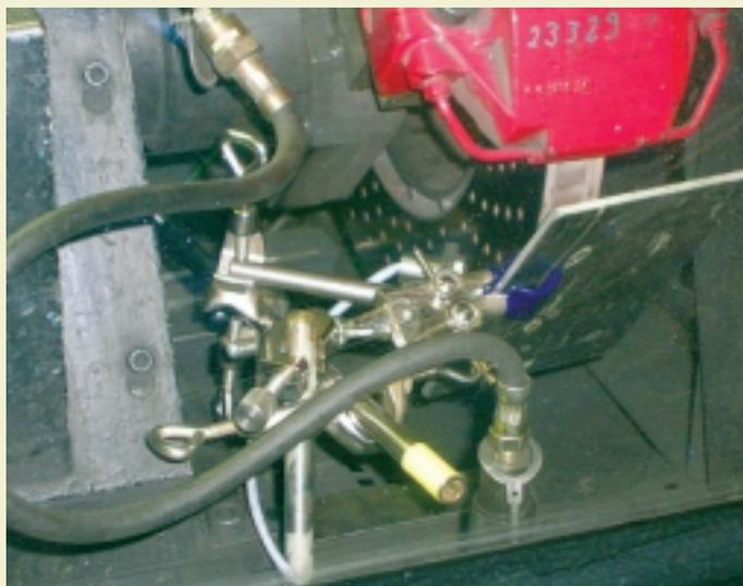
Abb. 6: Nahaufnahme des Bremsenprüfstandes mit neu lackiertem Testblech.
