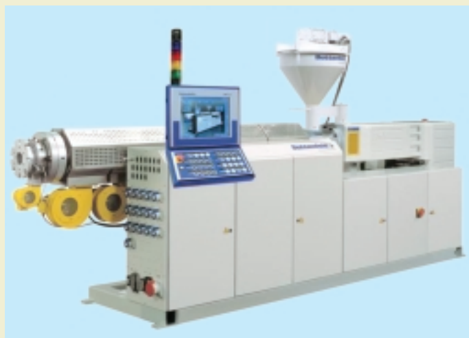
Abb. 1: Kooperationspartner des KTP ist u. a. die Firma Battenfeld aus Bad Oeynhausen, die komplette Extrusionslinien anbietet. Bestandteil einer solchen Linie ist dieser gegenläufige Doppelschneckenextruder 2-92-28V zur Herstellung von PVC-, Druck- und Abwasserrohren.
